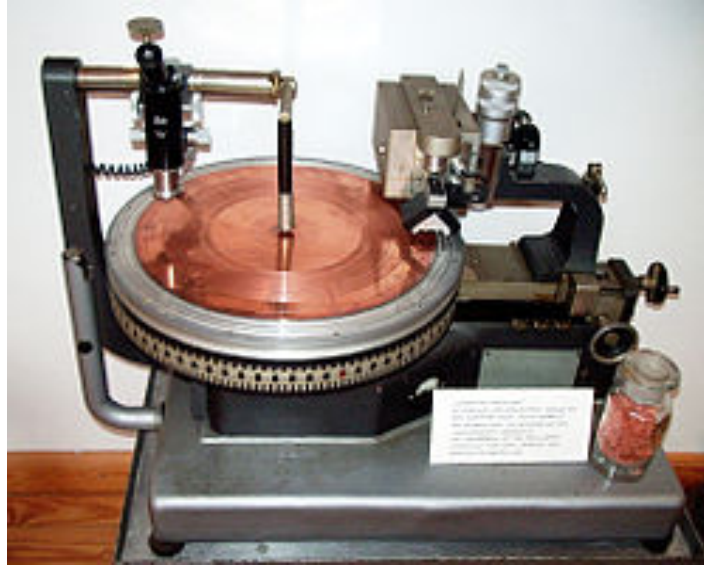
Maszyna do bezpośredniego nacinania matryc do tłoczenia płyt gramofonowych
